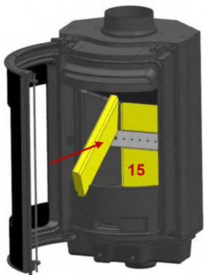
15: Insérer le réfractaire coté gauche à l'intérieur du corps
