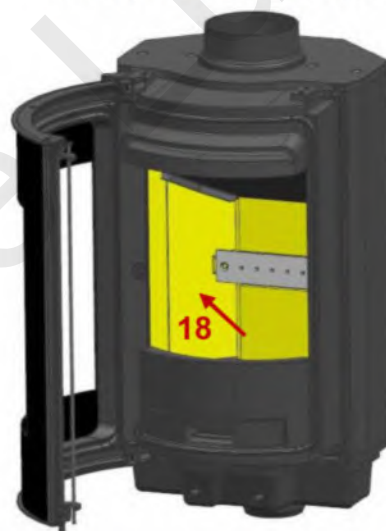
18 : Poser le réfractaire fond gauche sur la sole foyère et contre le fond.
